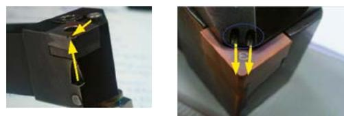
Figura 3: a) 2 boquillas dirigidas a las caras de incidencia y desprendimiento, b) boquilla doble hacia desprendimiento
