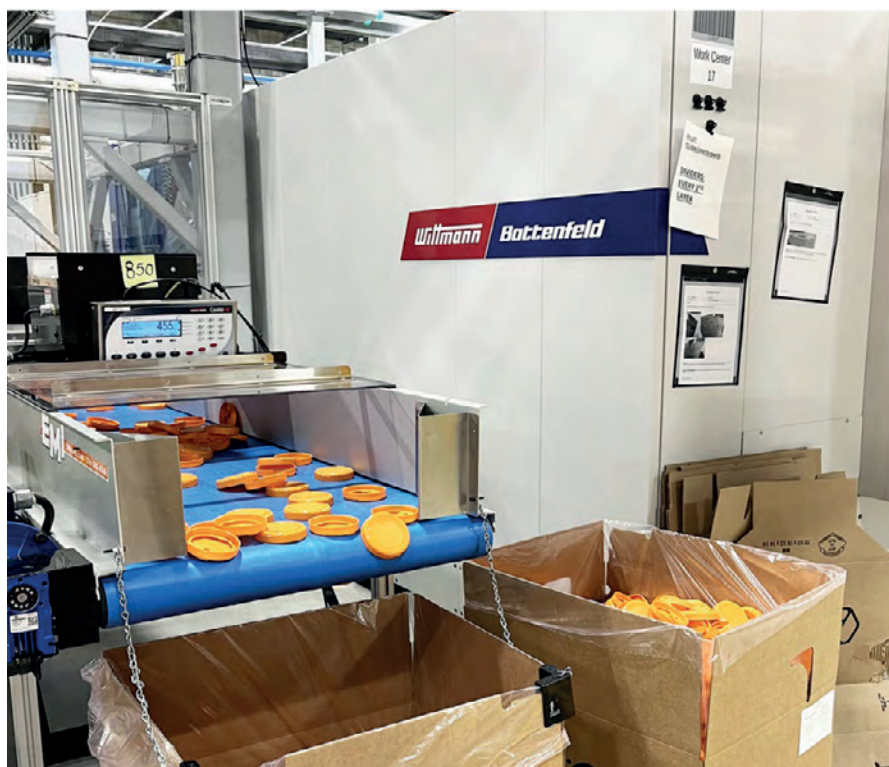
Las tapas de pared fina para envases redondos se fabrican en máquinas de moldeo por inyección del Grupo Wittmann en la planta de Comar en West Bend, en Wisconsin
