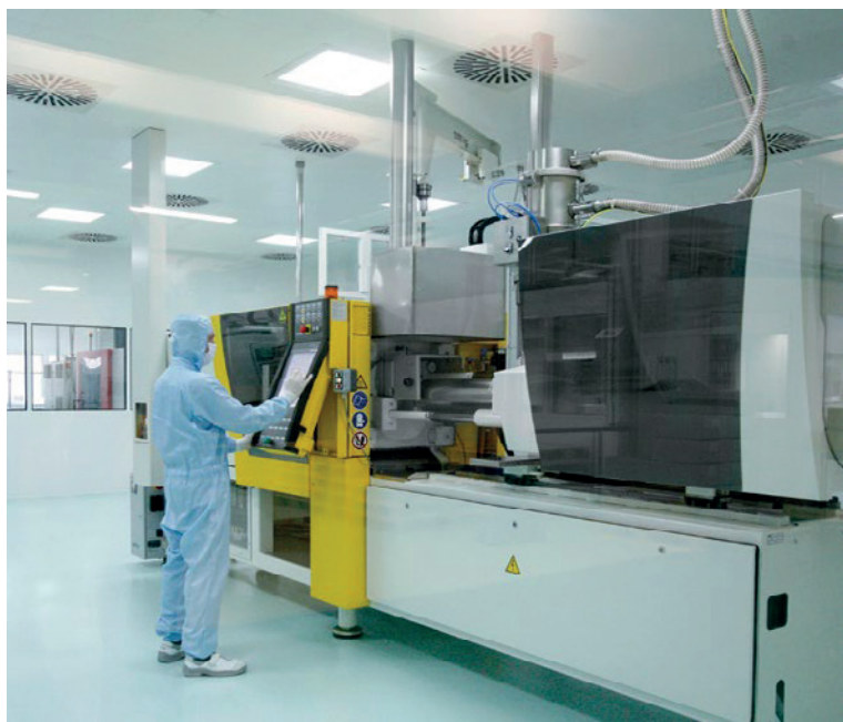
La Engel e-max de construcción compacta aprovecha de forma muy eficiente el espacio
