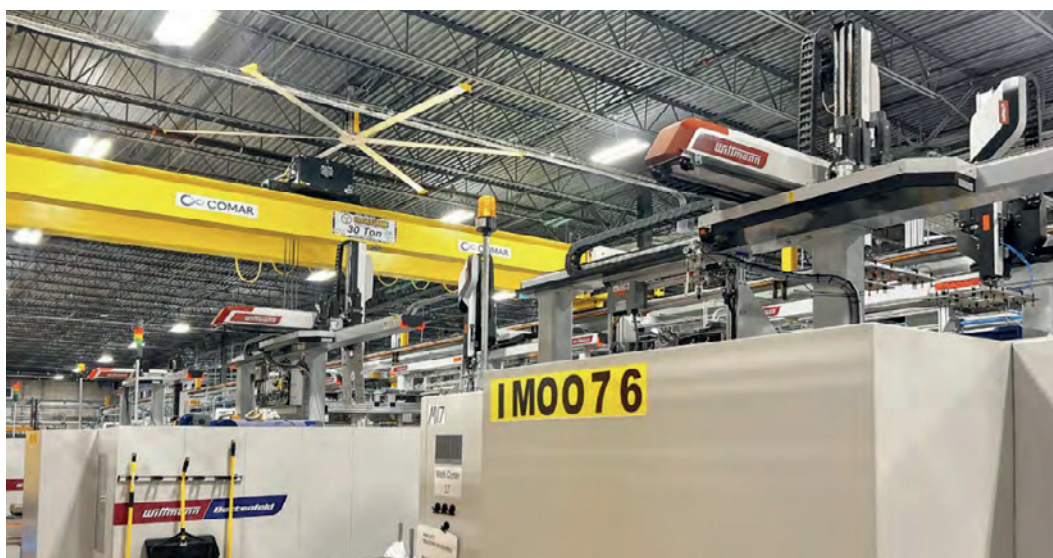
Cada una de las cuatro máquinas nuevas de Comar en West Bend está equipada con dos robots de alta velocidad W833 pro
