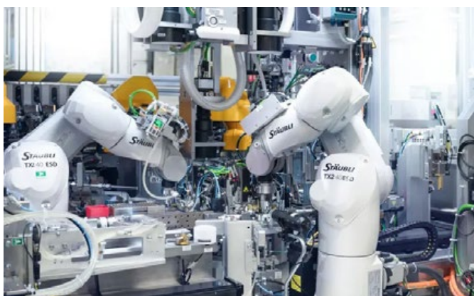
En un espacio muy reducido, cinco robots Stäubli y 18 sistemas de visión realizan el ensamblaje de módulos de sensores para sistemas de inyección diésel
