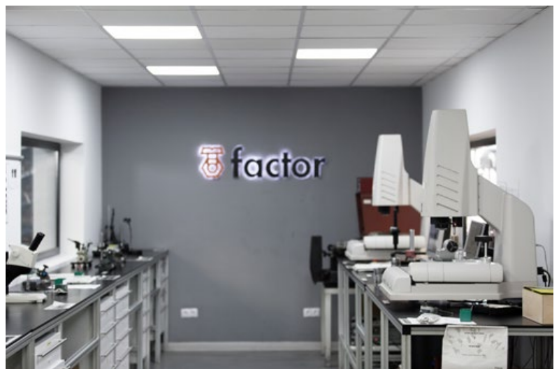
Laboratorio de Metrología equipado con dos unidades de MICRO-VU (centros de medición por visión), un sistema de medición instantánea Keyence, un proyector óptico de perfiles y una máquina de medición tridimensional
