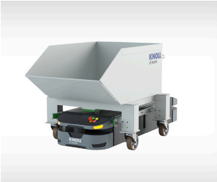
La automatización desempeñó un papel importante y aportó movimiento en el stand de KNOLL: por ejemplo, un AGV maniobrable transportó un carro portavirutas
