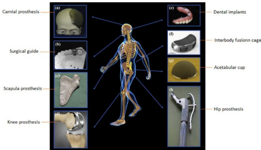
Aplicaciones de la impresión 3D de los biometales en diferentes partes del cuerpo humano
