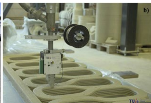
Plataforma de construcción digital - b) Máquina de impresión 3D de hormigón
