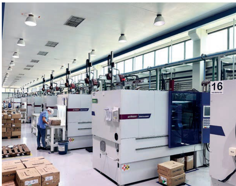
Un total de 44 máquinas de moldeo por inyección están en funcionamiento; la mayor parte la ocupan las SmartPower
